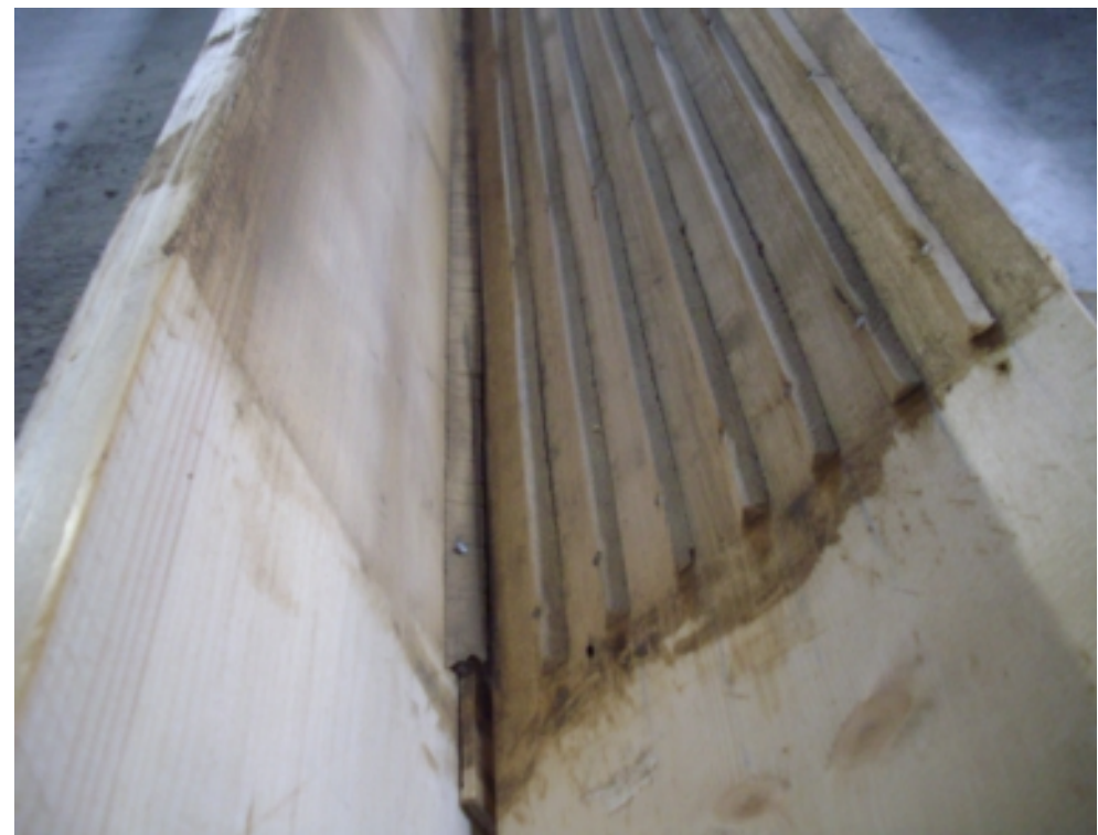
PARTICOLARE DEI LISTELLI PER LA FORMAZIONE DELLE SCANALATURE
